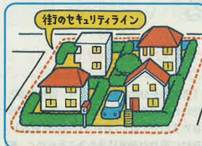
分譲地の出入口を中心に防犯カメラを設置し、いざというときには警備員が駆け付けるタウンセキュリティ
